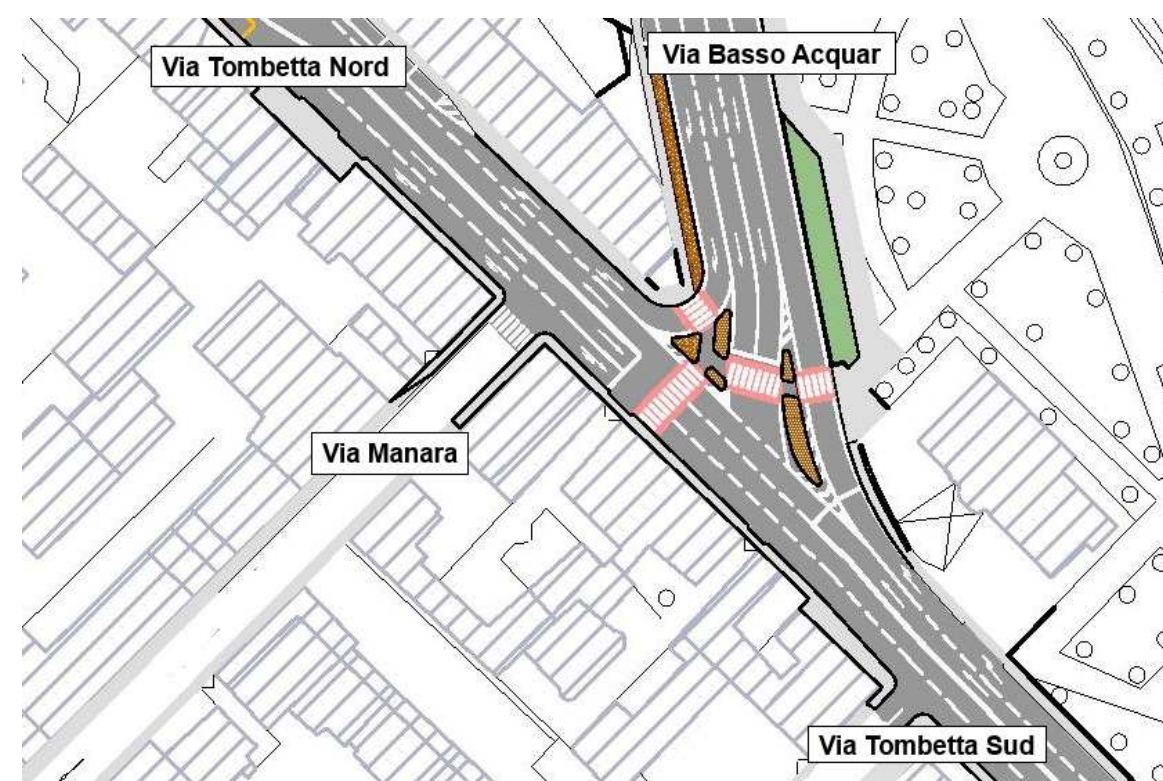
Figura 8-29: Nodo Via Tombetta-Via Basso Acquar - Stato di Progetto
