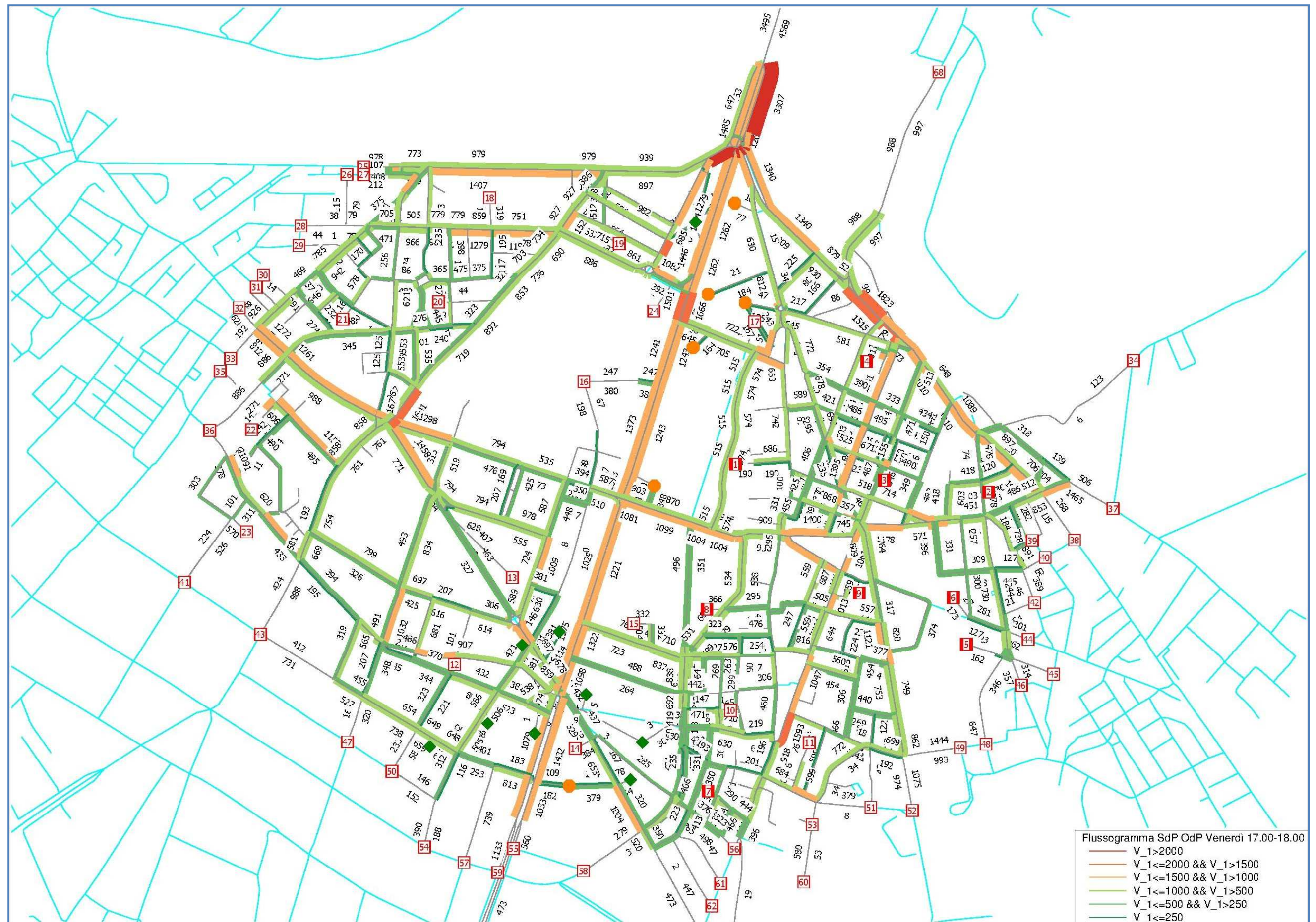
Figura 7-2: Flussogramma Venerdì Ora di Punta 17.00-18.00 - Stato di Progetto
